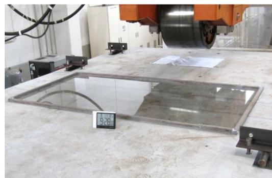
写真-4 漏水試験実施状況 (STEP-1)
