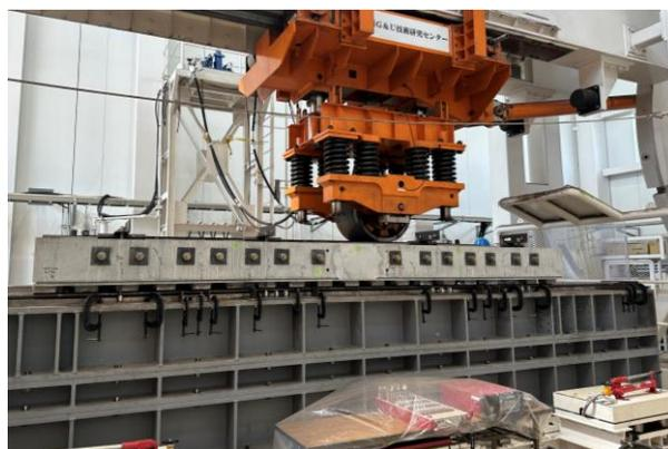
写真-3 輪荷重走行試験の実施状況
