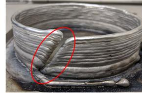
図-8 段差により生じたビードの不連続
