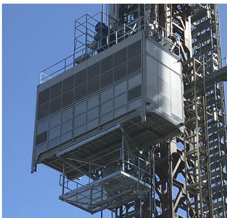
図-6 次世代型工事用エレベータ「SEC-5000RS」
